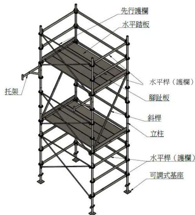
圖 1 系統式施工架各構件之示意圖
